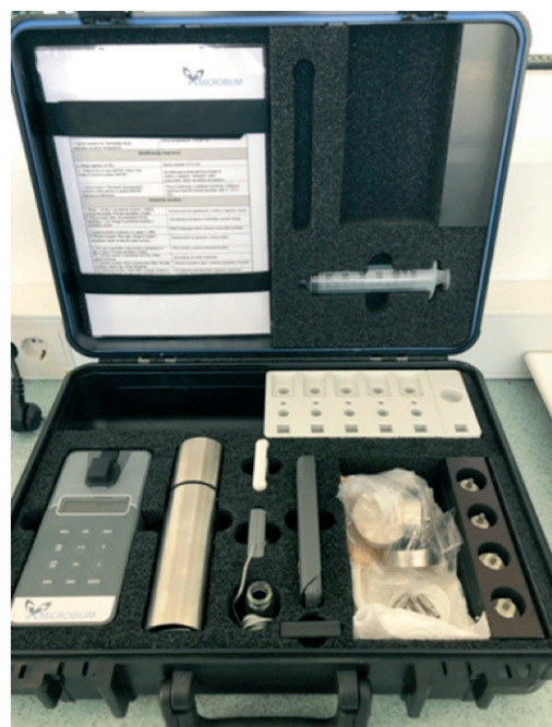
Slika 4: Merilna oprema za metodo Bactiquant (levo) in del procesa izvajanja analize Bactiquant (desno).
