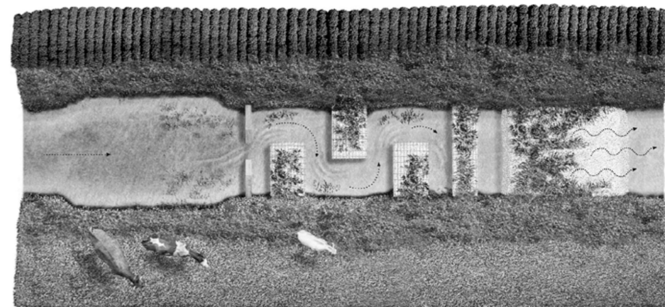
Slika 2: Tloris grajenega ekosistema, pri katerem si sledijo usedalnik, nato odsek meandriranja in na koncu čistilna greda s podpovršinskim tokom vode.
